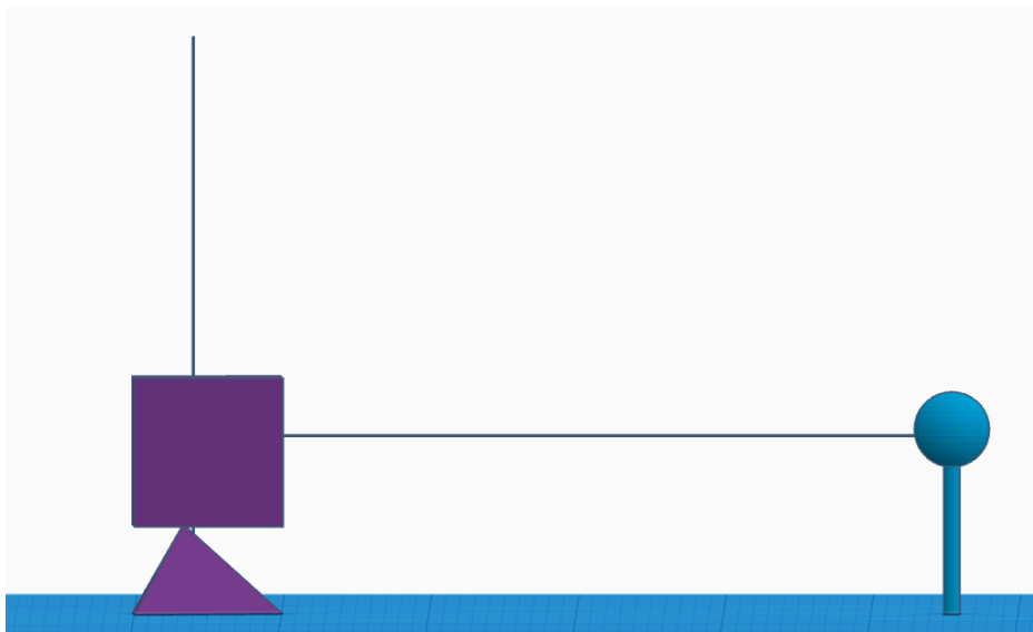
Figura 2: Vista lateral de uma ETR e um prisma. O ângulo entre o zênite do equipamento e o segmento de reta que liga a ETR ao prisma representa o ângulo vertical. Fonte: Elaborado pelo autor.
