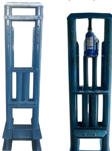
Figura 2. Equipamento confeccionado para a produção dos briquetes.
