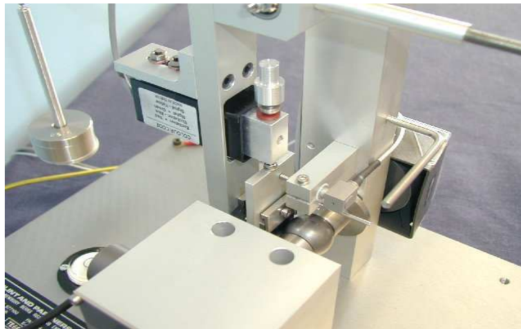
Figura 4.46 – Fotografia do equipamento de desgaste por microabrasão. Fabricação: Phoenix Tribology Ltda, modelo TE66 Micro-Scale Abrasion Tester.
