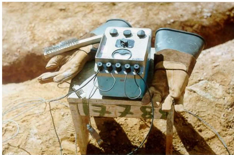
Figura 3.1 Equipamento para medição de Resistência de Terra – Megger
