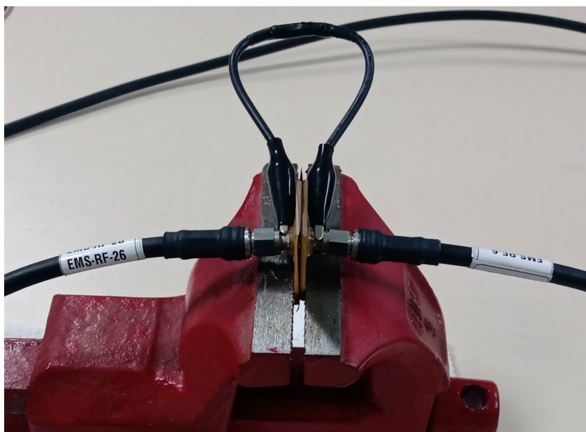
Figura 4.3: Setup utilizando as duas portas do VNA e o capacitor de placas paralelas preso por um torno de bancada.
