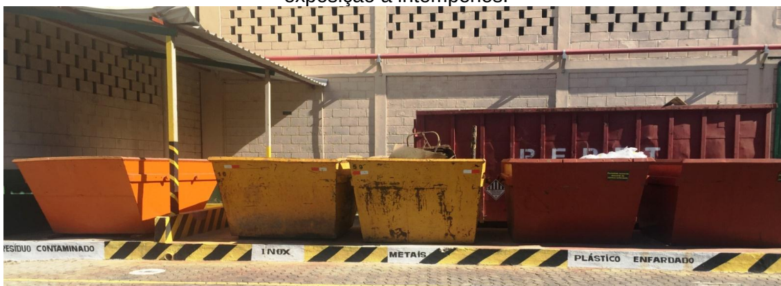
Figura 36 – Armazenagem de resíduos diversos com identificação e segregação, mas com exposição à intempéries.
