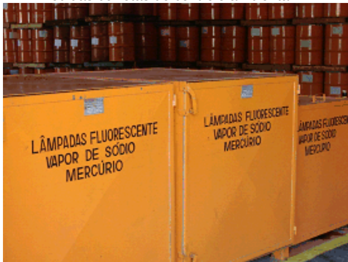
Figura 38 – Armazenamento de lâmpadas e outros resíduos devidamente segregados em acondicionadores identificados, e galpões com medidas corretas de controle ambiental.
