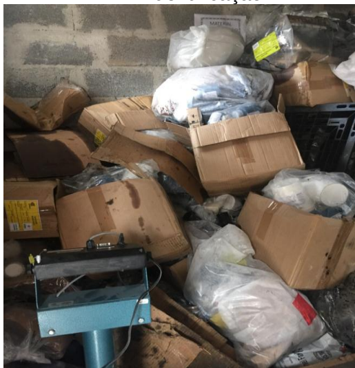
Figura 25 – Resíduos denominados sólidos contaminados perigosos, sem acondicionamento adequado, segregação, empilhados desordenadamente e sem identificação.
