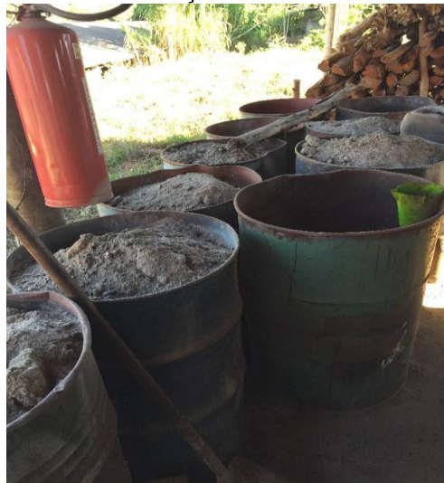
Figura 24 – Cinzas da caldeira sem nenhum tipo de cobertura para contenção em caso de condições climáticas adversas.
