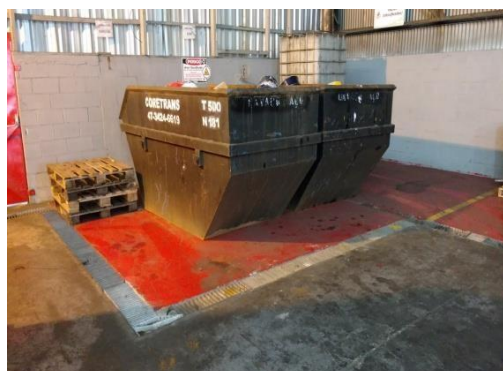
Isolamento por demarcação de pisos e canaletas
