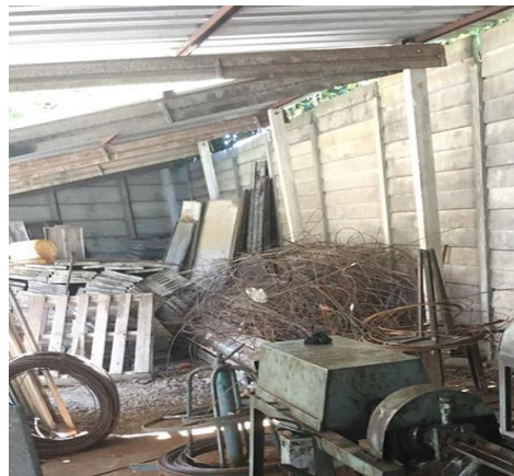
Figura 20 – Peças metálicas, pallets diversos armazenados no solo, sem controle ambiental, sujeito à corrosão e contaminação ambiental do solo.
