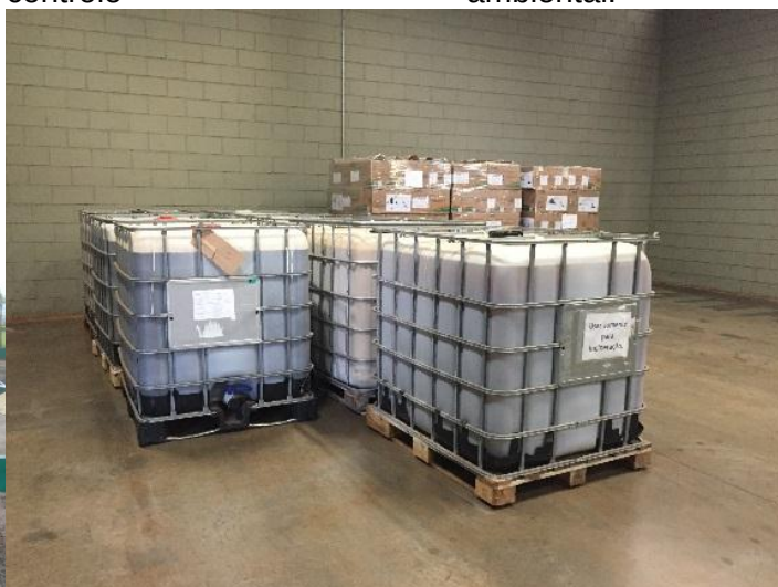
Figura 33 – Armazenagem de resíduos químicos em galpão, com identificação e controle ambiental.
