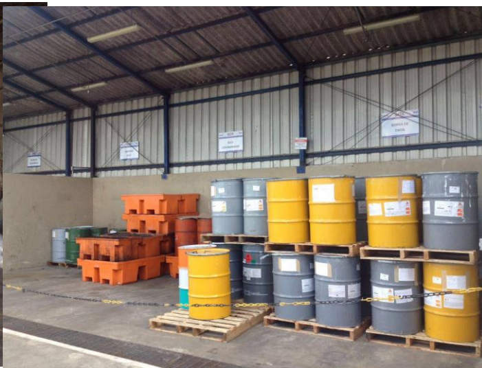
Figura 43 – Resíduos devidamente segregados e identificados, armazenados em local com o devido controle ambiental.
