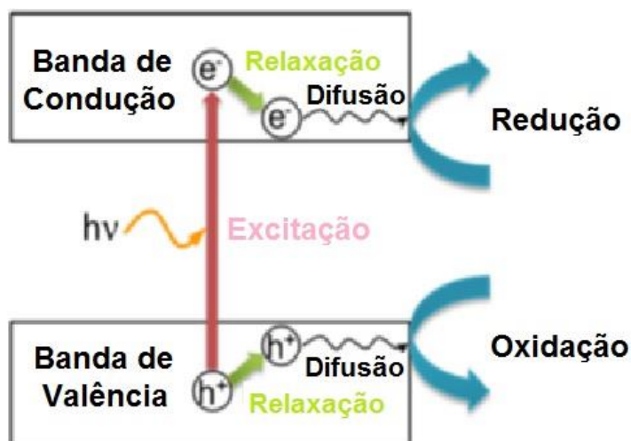
Figura 10 – Formação dos portadores de carga foto-gerados (elétron e buraco) no TiO 2 após absorção de luz ultravioleta. Fonte: Adaptado de NAKATA et al., 2012 [74].
