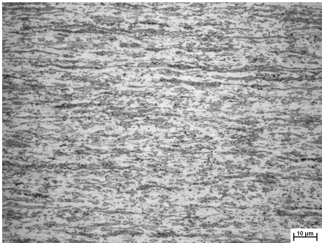
Figura 5.3 – Aspecto microestrutural após laminação a frio. MO. Nital 4%.
