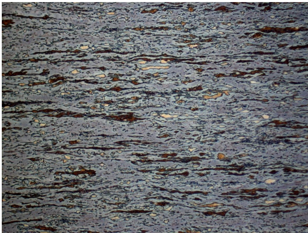
Figura 5.4 – Aspecto microestrutural após laminação a frio. MO. Metabissulfito de sódio.
