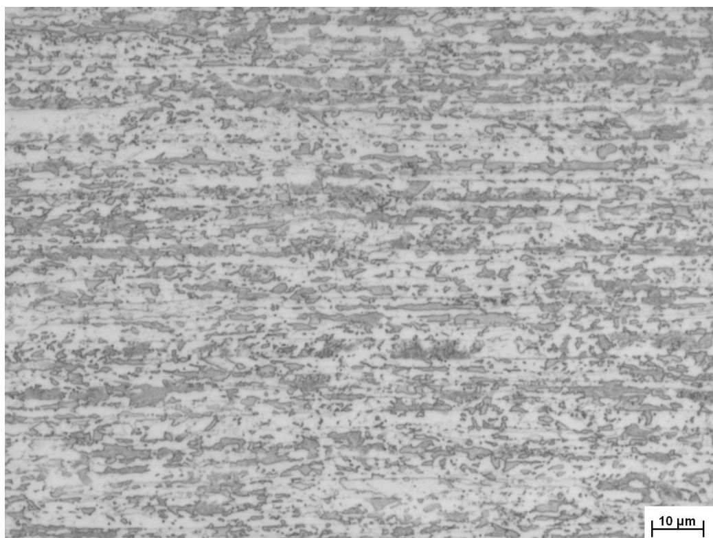
Figura 5.1 – Aspecto microestrutural após laminação a quente. MO. Nital 4%.
