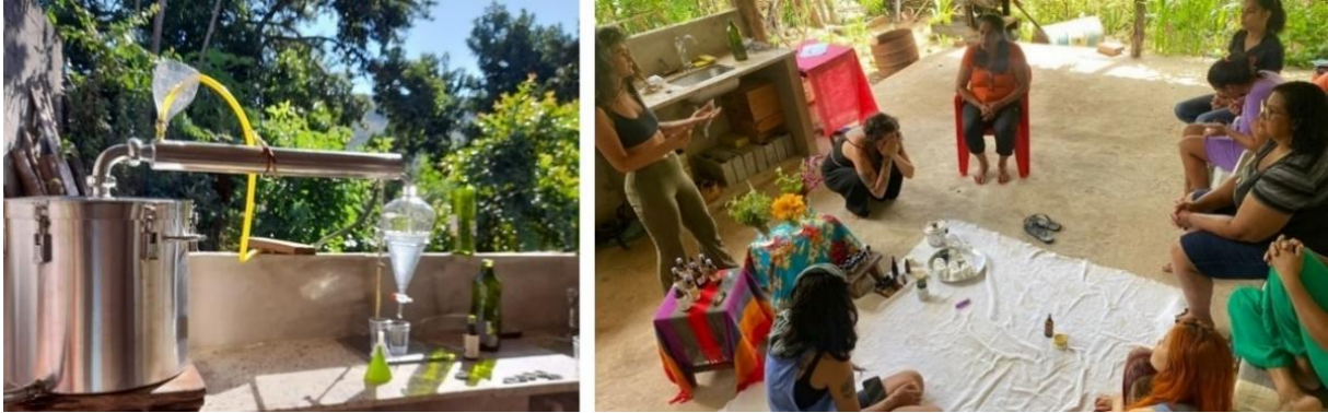
Figura 24. Destilação de óleo essencial
