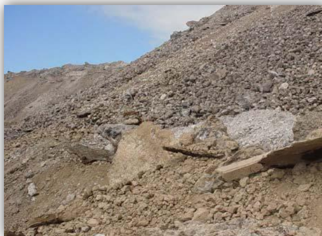
Figura 27 - Depósito de escória de aciaria, enquanto aguarda o processo de reciclagem
