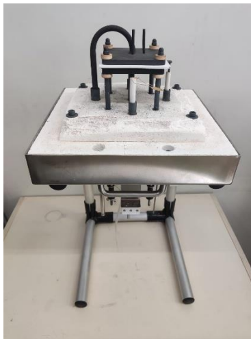
Figura 16 - Imagens da montagem da pilha no forno de medida.
