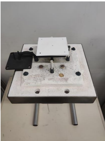
Figura 16 - Imagens da montagem da pilha no forno de medida.
