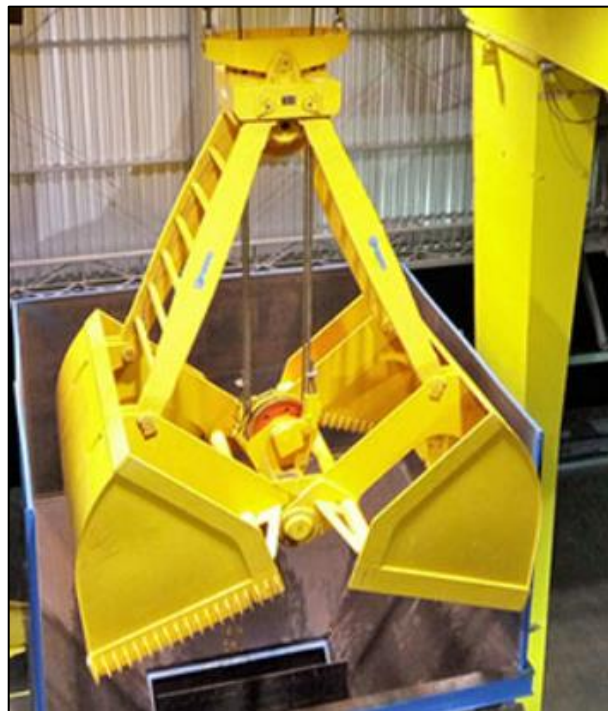
Figura 2 – Sistema de conchas. (fonte: Ferroindustria, 2024. Disponível em: < https://www.ferroindustria.com.br/descarregador-navio >. Acesso em: 16 Out 2024)
