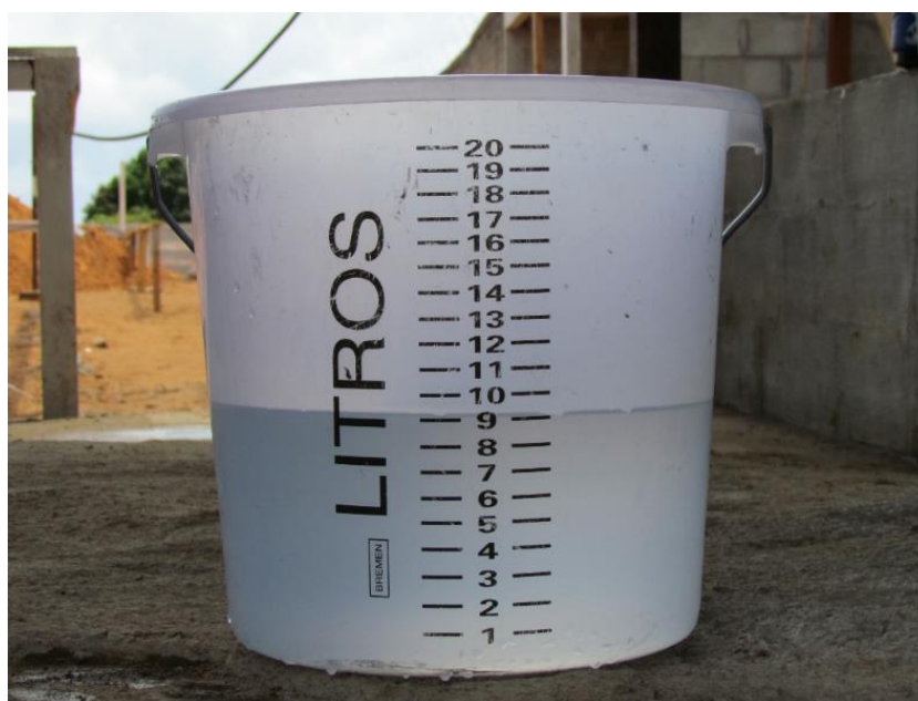
Figura 3.3: Balde graduado para medição de volumes de cimento, areia, brita e água.
