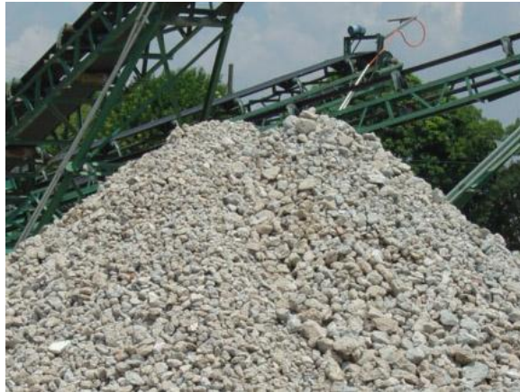
Figura 05: Rachão Reciclado Fonte: Site SC Construtora (2011)
