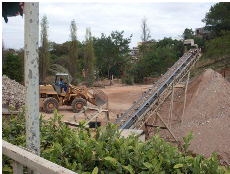
Figura 21: Pilha da Correia, após a britagem. Fonte: Pesquisa Direta, 2012.
