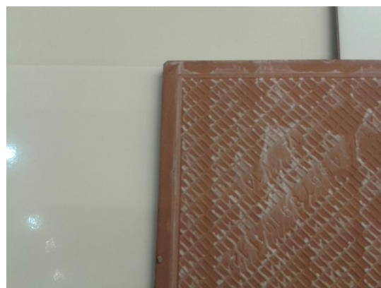
Figura 4: Placa cerâmica prensada com tardoaz vermelho e polidirecionado
