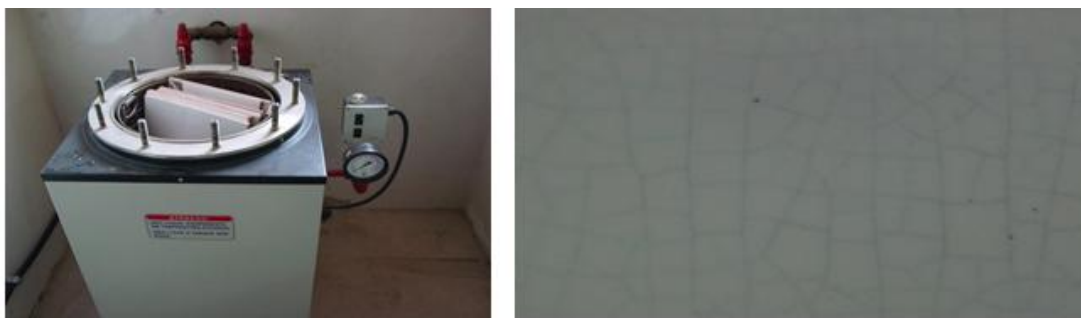
Figura 6: Imagem do equipamento realizado para o teste e exemplo de peça que apresenta gretagem
