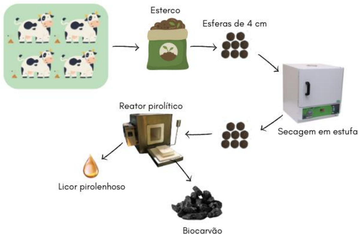
Figura 3: Esquema da produção do biocarvão de esterco bovino por pirólise lenta.
