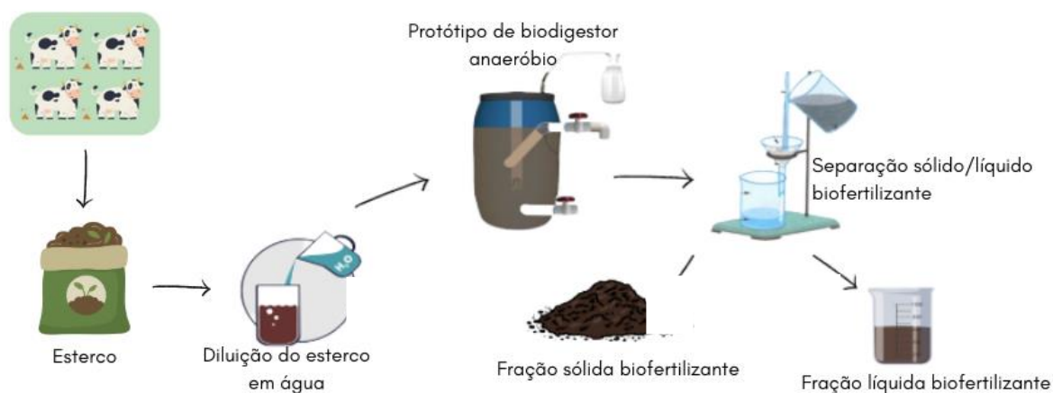
Figura 4: Esquema da produção do biofertilizante de esterco bovino por biodigestão anaeróbica.
