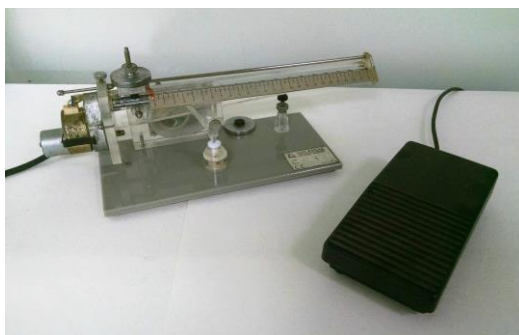
Figura 8. Analgesímetro - aparato utilizado para realizar a medida do limiar nociceptivo na pata de ratos.
