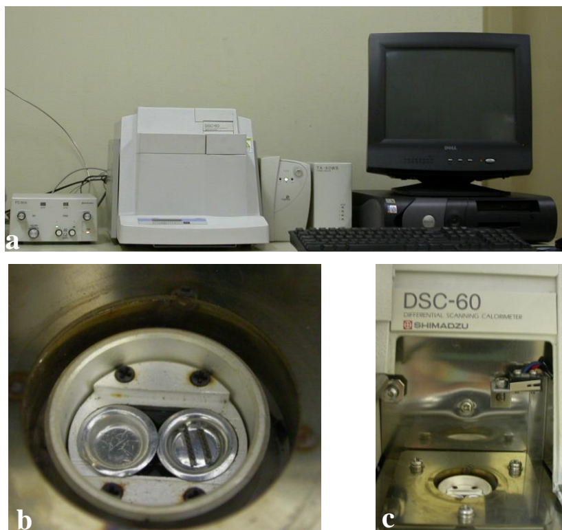
Figura 4.2 - a) Aparelho Shimadzu DSC60 com computador acoplado; b) Preparo da amostra; c) Compartimento dos termopares.
