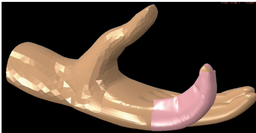
FIGURA 4.2 - Simulação do movimento de flexão do indicador por ação da órtese de mão.
