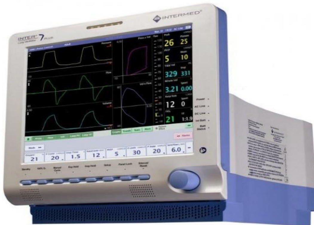
FIGURA 6. Ilustração de um ventilador mecânico microprocessado com apresentação de curvas de volume, fluxo e pressão ao longo do tempo. Fonte: < http://www.priom.com.br/infoProduto.php?p=61 >
