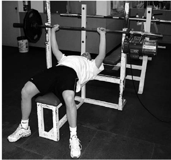
Figura 7 – Adição de vibrações mecânicas diretamente no peso a ser deslocado
