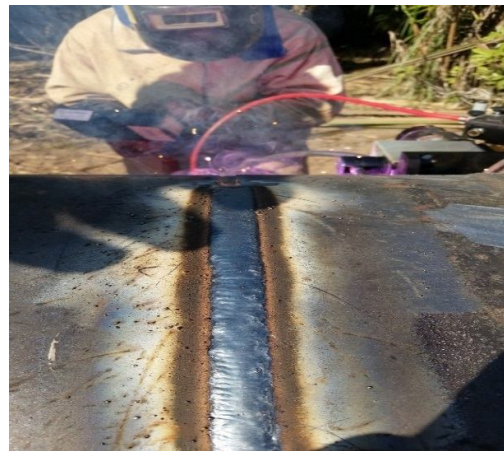
Figura 02: Soldagem FCAW Orbital: Pipe Kat PK200 / Pk500 Figura 03: Excelente acabamento da solda FCAW
