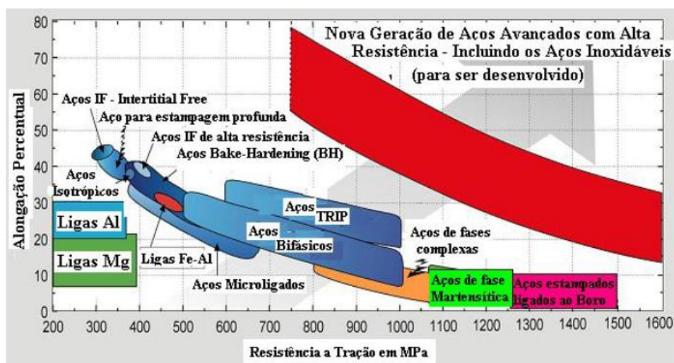
Figura 3.1. Relação entre resistência mecânica e conformabilidade de aços convencionais e de aços avançados de elevada resistência mecânica (CORREA, 2012).
