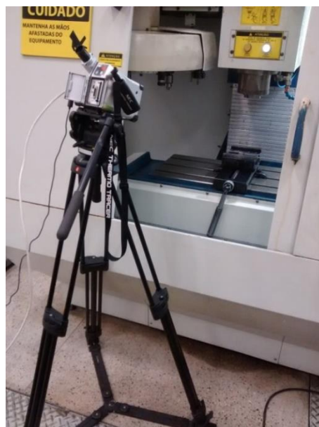
Figura 3.4 – Aparato experimental para medição das temperaturas do processo de deposição Fonte: dados do autor
