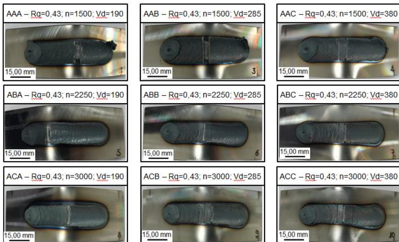
Figura 4.24 – Imagens das amostras do grupo A ( R_q = 0,43 \mu m ) após ensaio de dobramento.
