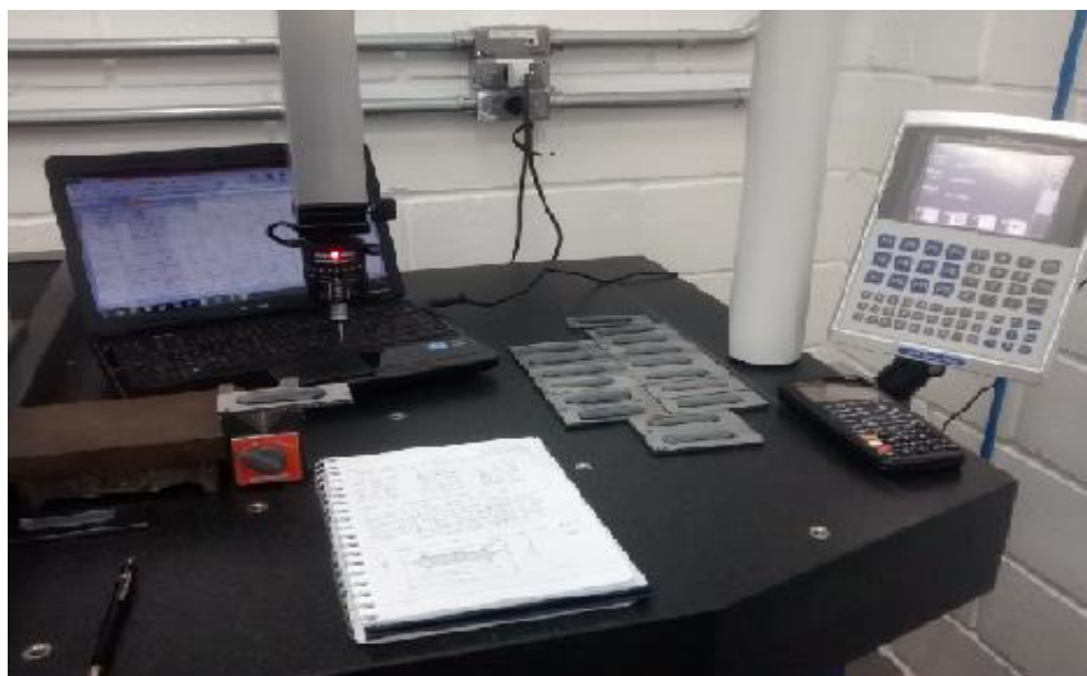
Figura 3.6 – Montagem da MMC para medição das dimensões dos revestimentos Fonte: dados do autor
