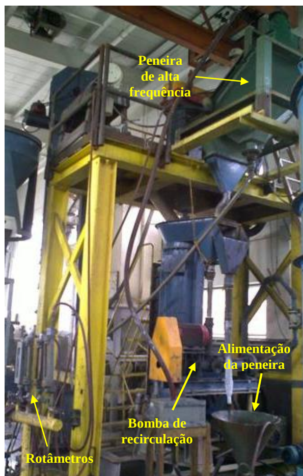
Figura 4.3 – Vista da peneira de alta frequência e da bomba de recirculação (VALE 1 )
