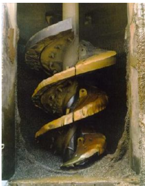
Figura 3.6 – Detalhe do maior desgaste dos revestimentos da parte inferior da espiral 1
