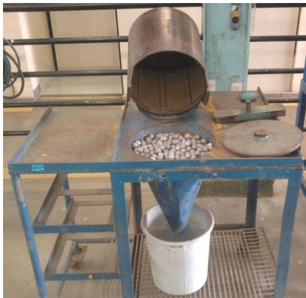
Figura 4.6 – Moinho de bolas de 254mm x 254mm utilizado nos testes em escala de laboratório.
