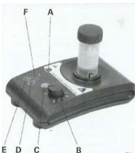
Figura 1 - Descrição do moedor Ultra Turrax. (A) Botão Liga-Desliga. (B) Botão de ajuste de velocidade. (C) Botão Start-Stop. (D) Botão Timer: ajuste de unidades. (E) Botão Timer: ajuste de dezenas. (F) Display de tempo.
