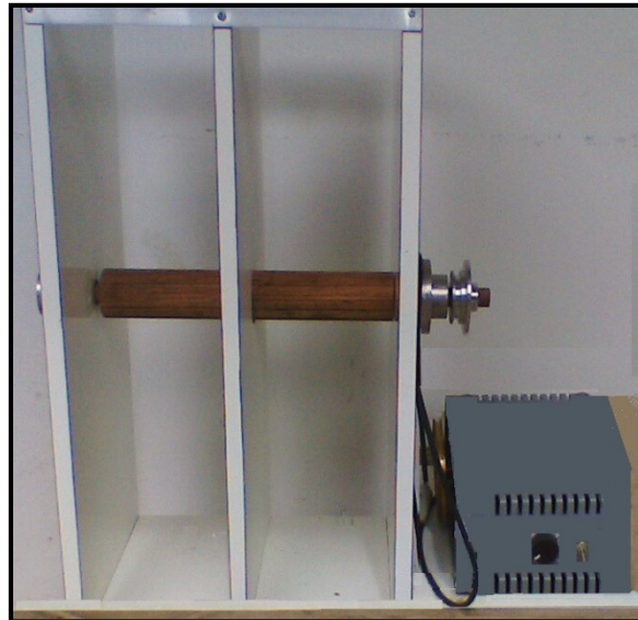
Figura 5: Fotografia do equipamento utilizado para a avaliação do equilíbrio e coordenação motora dos animais ( Rotarod ).
