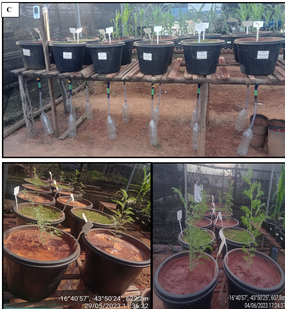
Figura 1 (C) – Bancada mostrando a localização montagem e disposição dos lisímetros na estufa localizada na área experimental da Universidade Federal de Minas Gerais – ICA, campus de Montes Claros
