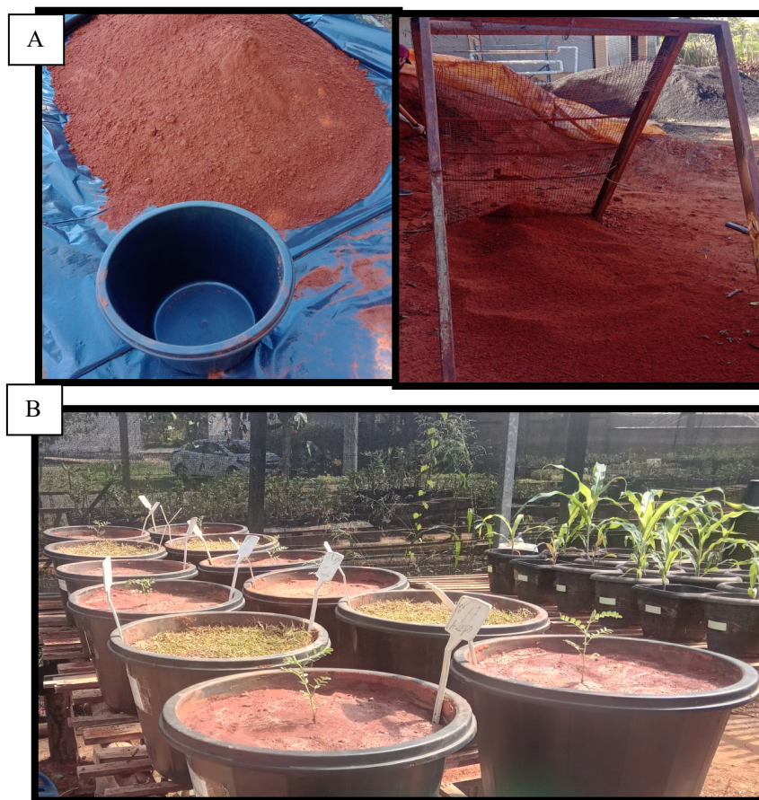
Figura 1 (A, B) – Bancada mostrando a localização, montagem e disposição dos lisímetros na estufa
