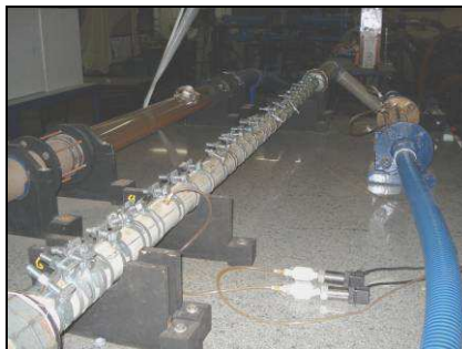
Figura 4.7: Detalhe da tomada de pressão. À esquerda, conexão dos piezômetros e transmissores no trecho de testes. À direita, detalhe do transmissor eletrônico de pressão.
