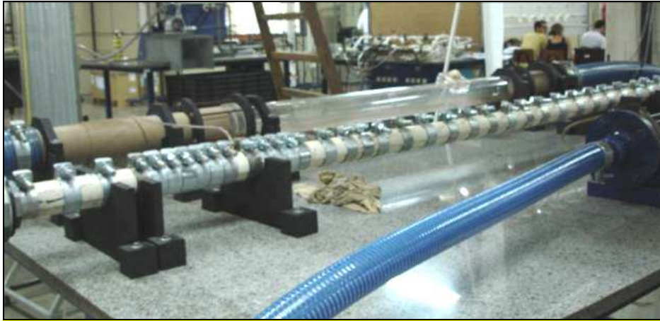
Figura 4.5: Vista geral da bancada preparada para o início dos testes de perda de carga em condutos infestados por Limnoperna fortunei .
