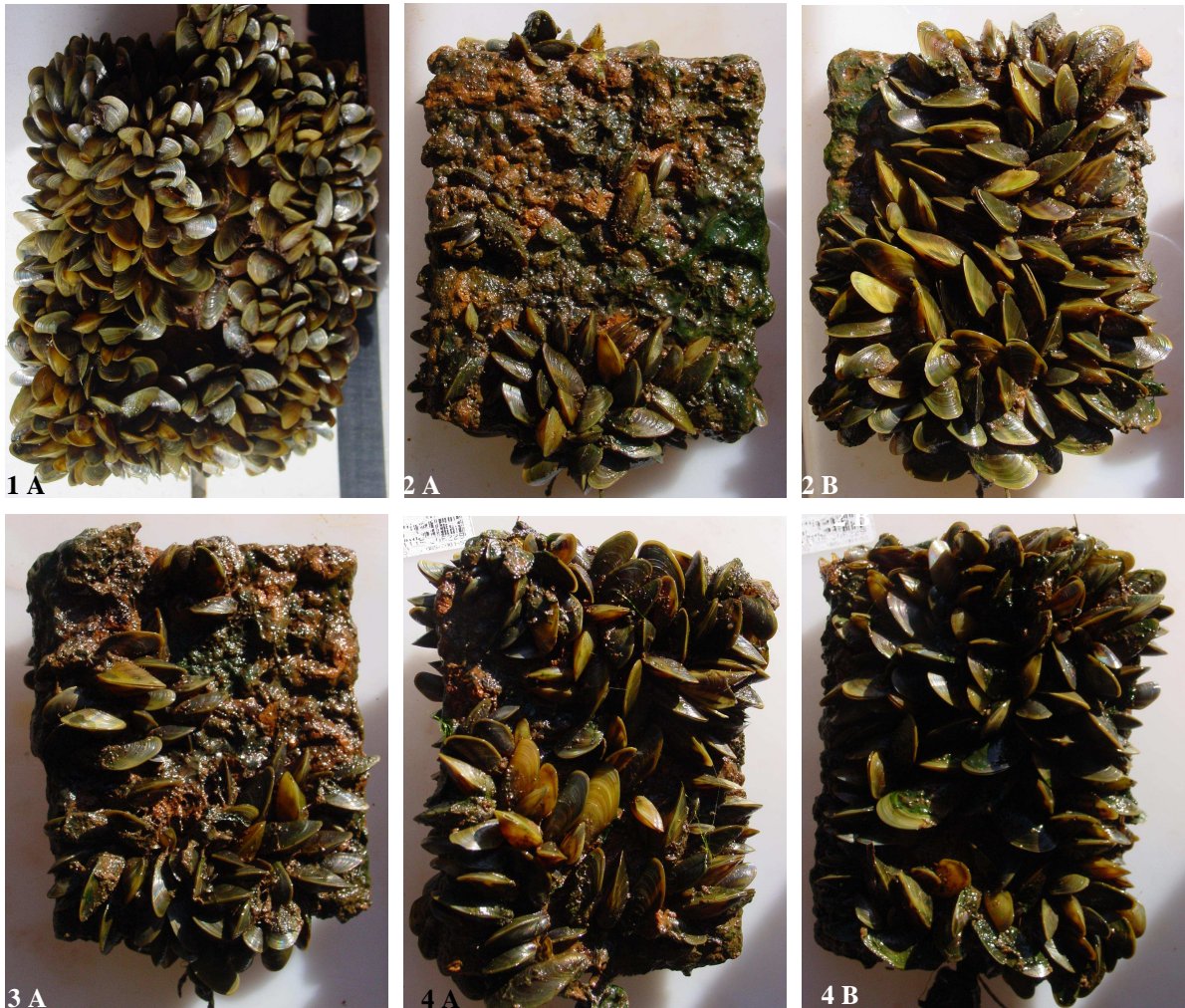
Figura 1: Fotos de placas (8 x 10 cm) ensaiadas submersas em setembro/2009. As letras A e B diferenciam os lados das placas.
