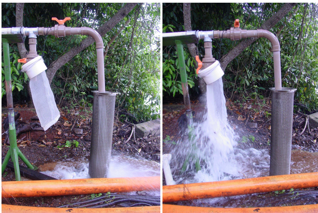
Figura 4.27: Coleta de mexilhões soltos em cada vazão e nos intervalos de troca de vazões. À esquerda: coleta no cilindro em inox. À direita: coleta em saco de nylon de malha 1 mm.
