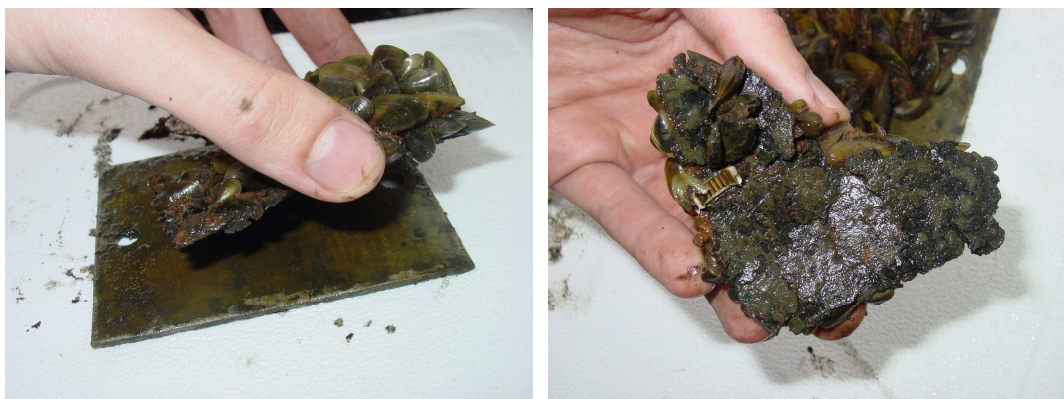
Figura 5.31: Processo de oxidação em placa de aço carbono com 13 meses de submersão.
