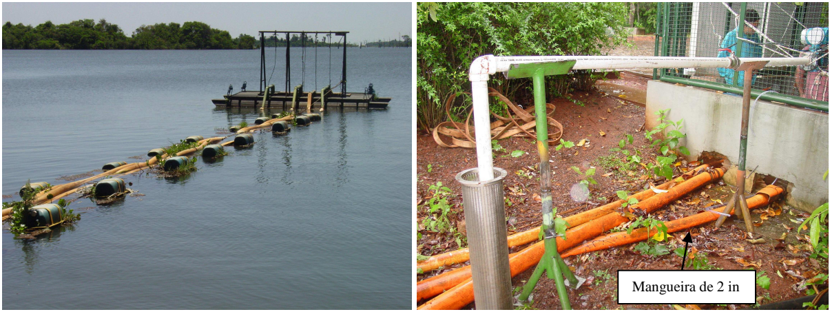
Figura 4.23: À esquerda, plataforma flutuante onde estão localizadas as bombas submersas com mangueiras para condução de água. À direita, detalhe da mangueira de 2 in de abastecimento do aparato de testes.
