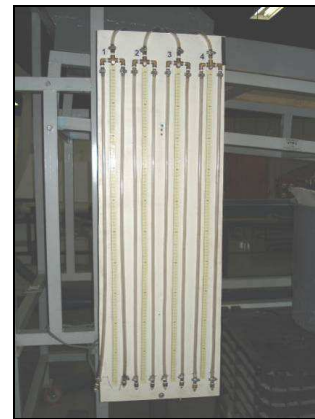
Figura 4.6: Detalhe dos instrumentos de medição de pressão. À esquerda, circuito eletrônico – unidade de tensão e amperímetros. À direita, manômetro de tubo em “U”.
