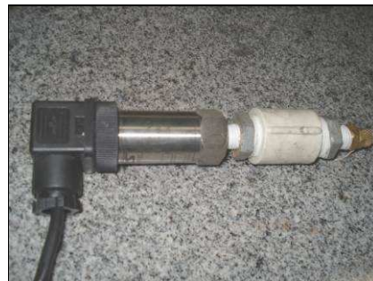
Figura 4.7: Detalhe da tomada de pressão. À esquerda, conexão dos piezômetros e transmissores no trecho de testes. À direita, detalhe do transmissor eletrônico de pressão.
