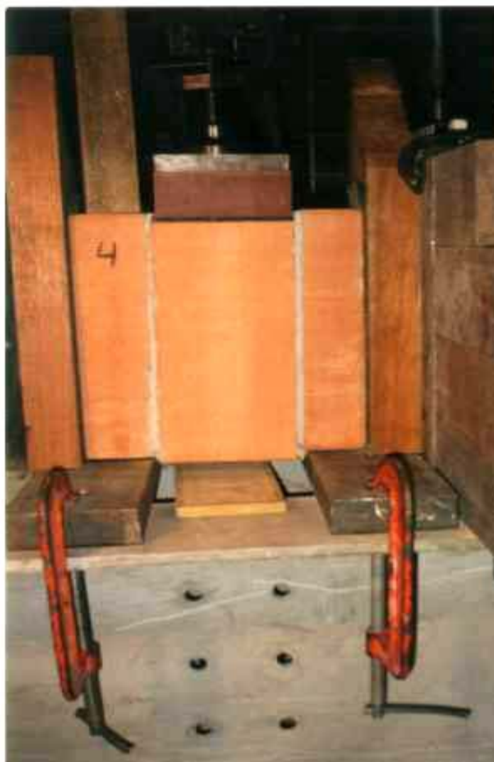
Figura 84 – Deslizamento do bloco central em relação aos das extremidades
