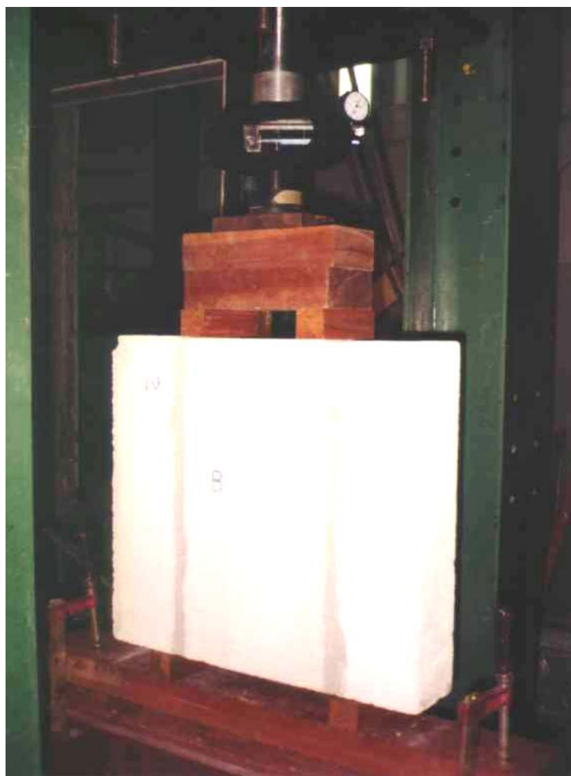
FIGURA 54 - Procedimento (b) “Força próxima a junta”
