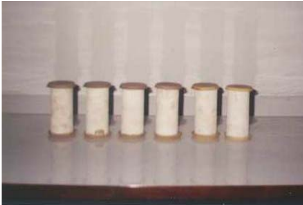
FIGURA 33 – Corpos-de-prova de argamassa
