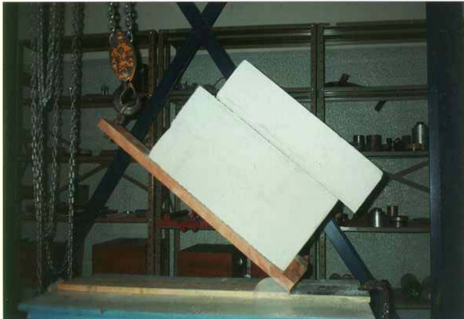
FIGURA 47 - Deslizamento do bloco em relação a junta de argamassa
