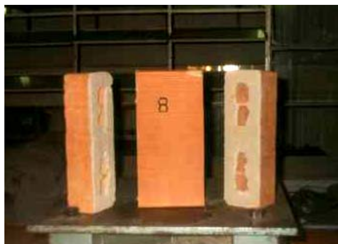
Figura 83 – Descolamento de ambas as juntas de argamassa
