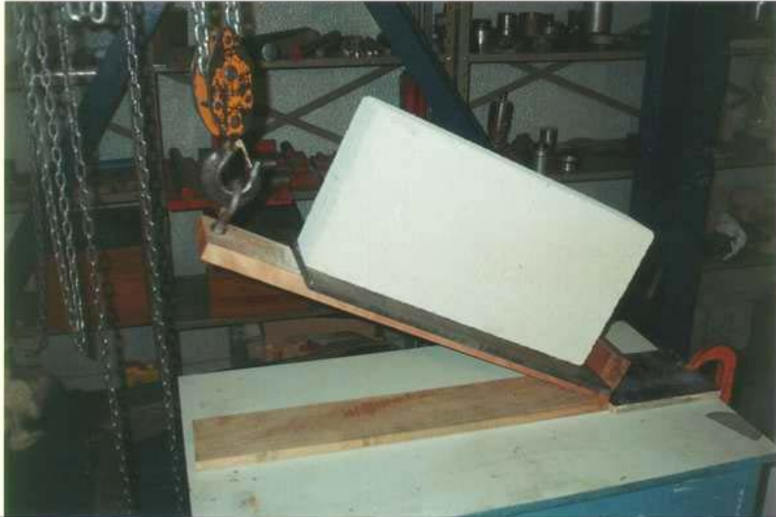
FIGURA 49 - Deslizamento do bloco em relação a chapa de aço
