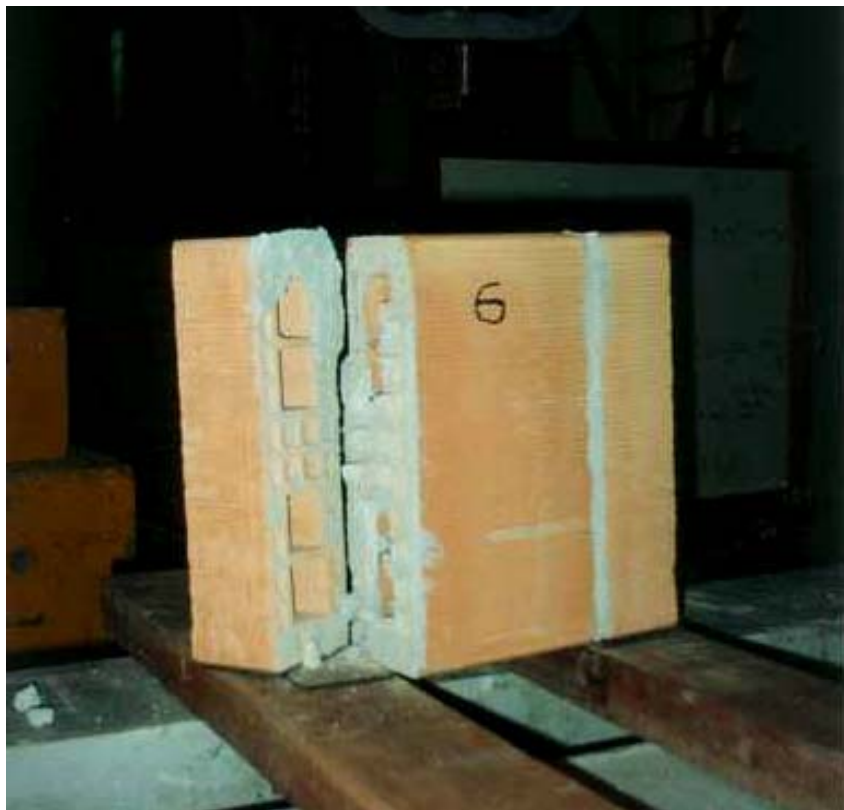
Figura 80 – Descolamento total entre bloco e argamassa
