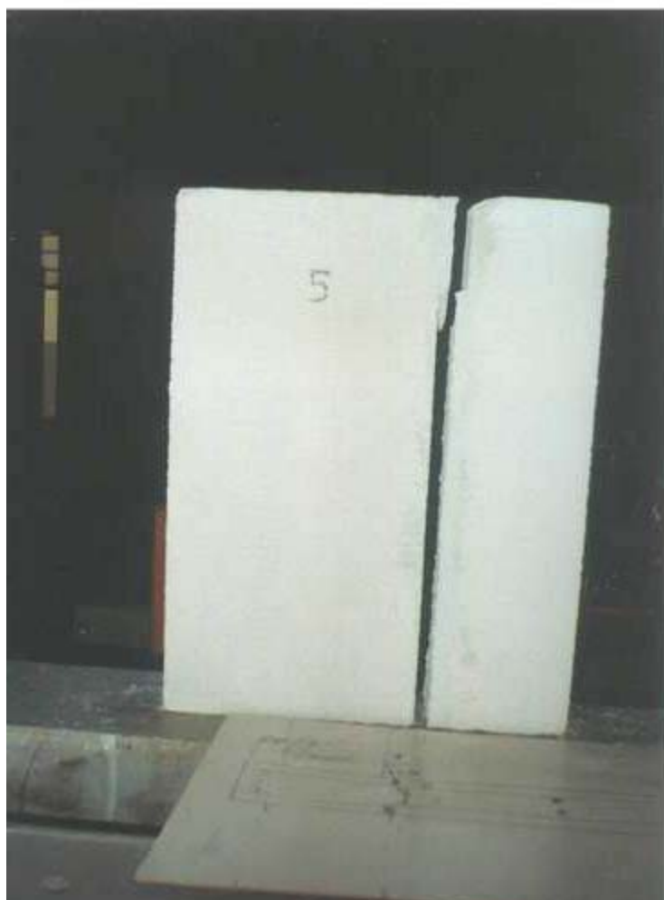
Figura 71 – Descolamento em ambas interfaces unidade/argamassa
