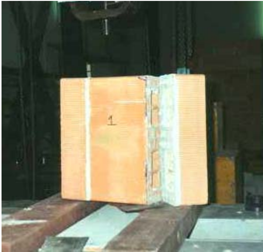
Figura 81 – Descolamento total entre bloco e argamassa
