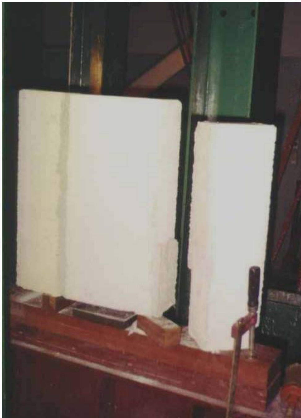
Figura 79 – Descolamento em ambas interfaces unidade/argamassa
