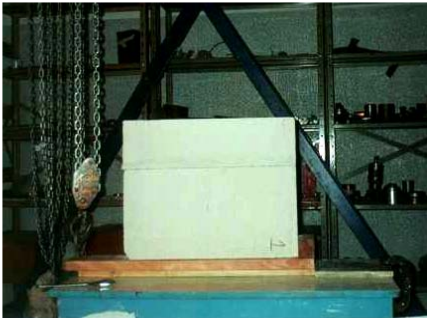
FIGURA 46 - Ensaio de plano inclinado entre bloco e junta de argamassa
