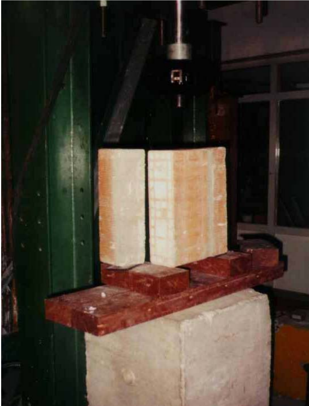
Figura 85 – Descolamento total entre bloco e argamassa
