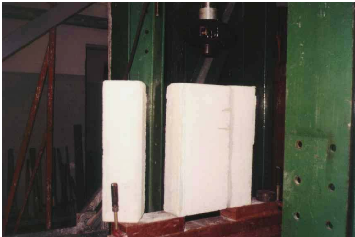
Figura 78 – Descolamento total entre bloco e argamassa
