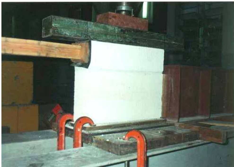
FIGURA 44 – Ensaio dos prismas E4PS2-A
