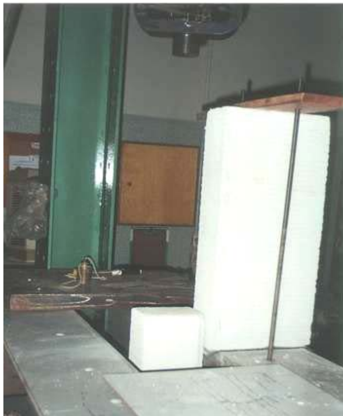
Figura 70 – Descolamento total entre bloco e argamassa
