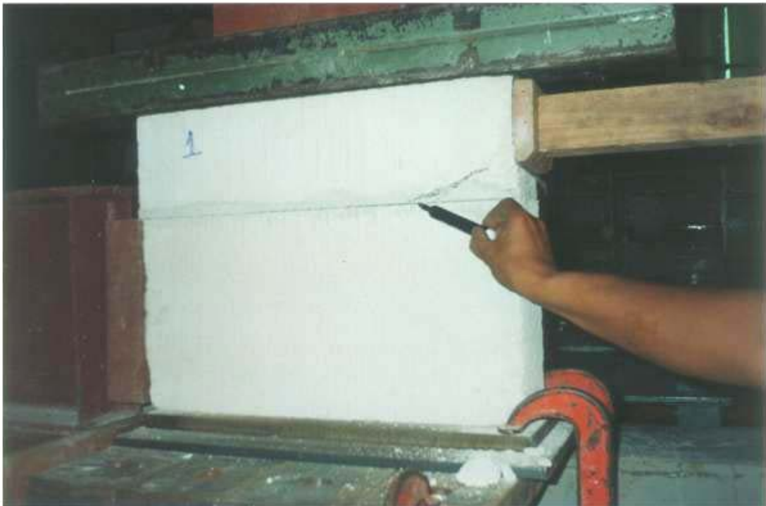
Figura 76 – Ruptura na argamassa
