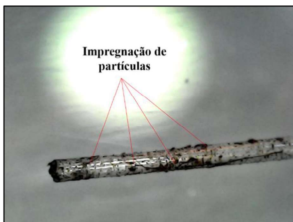
Figura 13. Fibra de SPME danificada por impregnação com partículas de matriz sólida. A imagem foi tirada com uma Lupa Eletrônica de Microscópio Digital com ampliação de 1600x.
