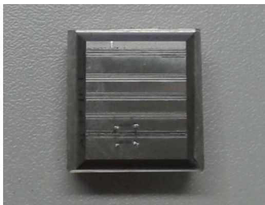
Figura 4.2: Amostra de níquel microusinada com sulcos de 30 e 50 micrômetros de profundidade usada na verificação da coordenada z dos modelos reconstruídos via MeX. A avaliação foi realizada na área marcada de 2x3 mm (amostra fornecida pelo Prof. Marcelo Câmara do Departamento de Engenharia Mecânica da UFMG).
