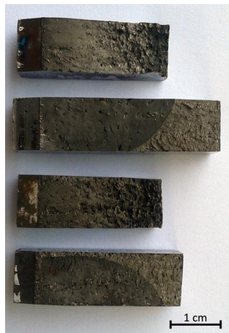
Figura 4.1: Corpos de prova de fadiga de solda subaquática selecionados, na ordem CC10, RC10, CC90 e RC90.
