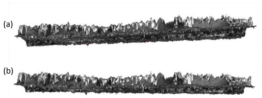
Figura 5.11: Vista frontal da região reconstruída da amostra de Ni: (a) antes e (b) após ajuste no Workpiece Coordinate System .
