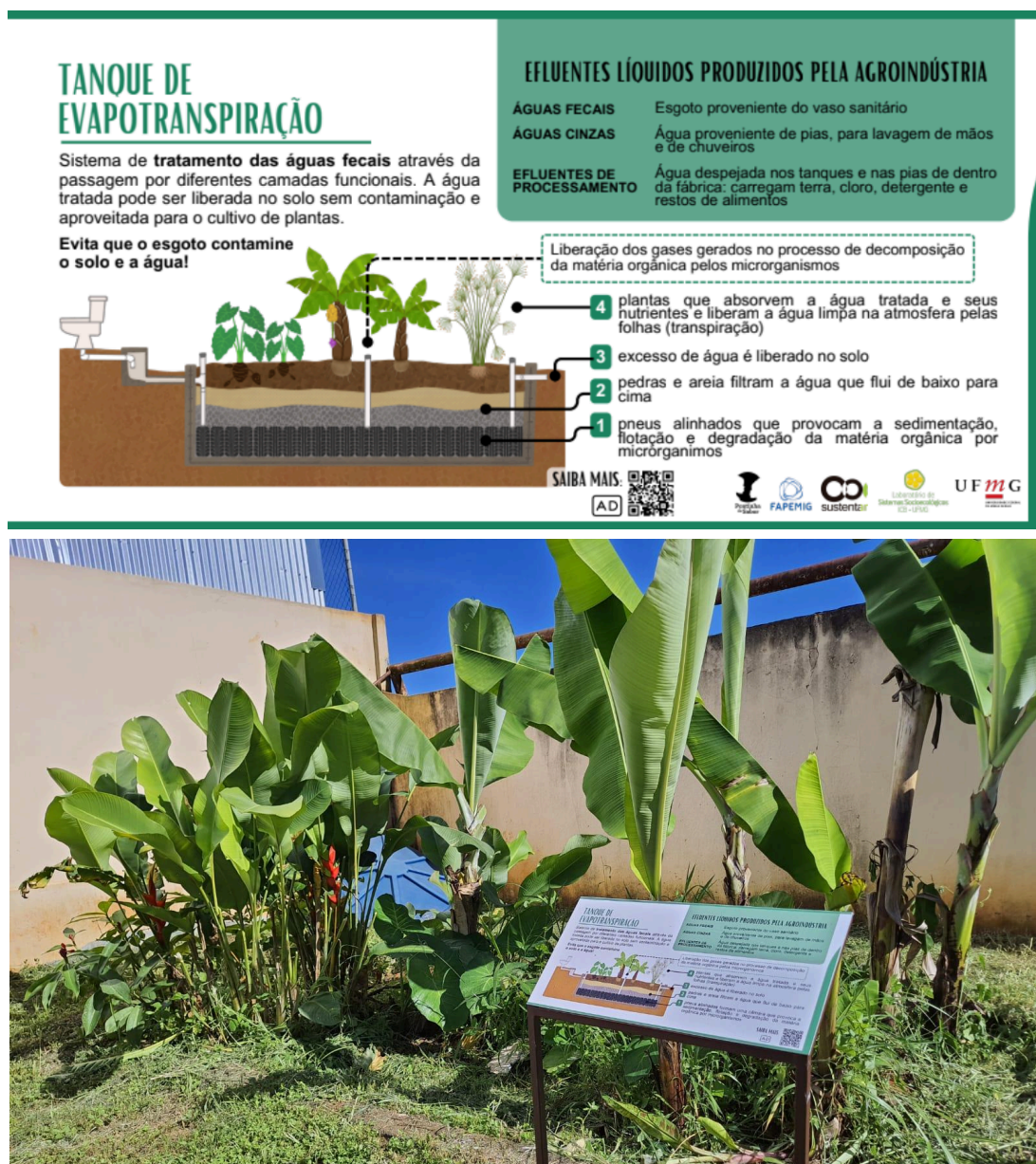
Figuras 19 e 20: Na imagem superior, placa informativa sobre a tecnologia de Tanque de Evapotranspiração para captação e tratamento de efluentes domésticos. Na imagem inferior, a placa acima em exposição junto à tecnologia de referência na agroindústria Pontinha de Sabor, no Quilombo da Pontinha, Paraopeba, Minas Gerais. Fonte: Acervo do Laboratório de Sistemas Socioecológicos.
