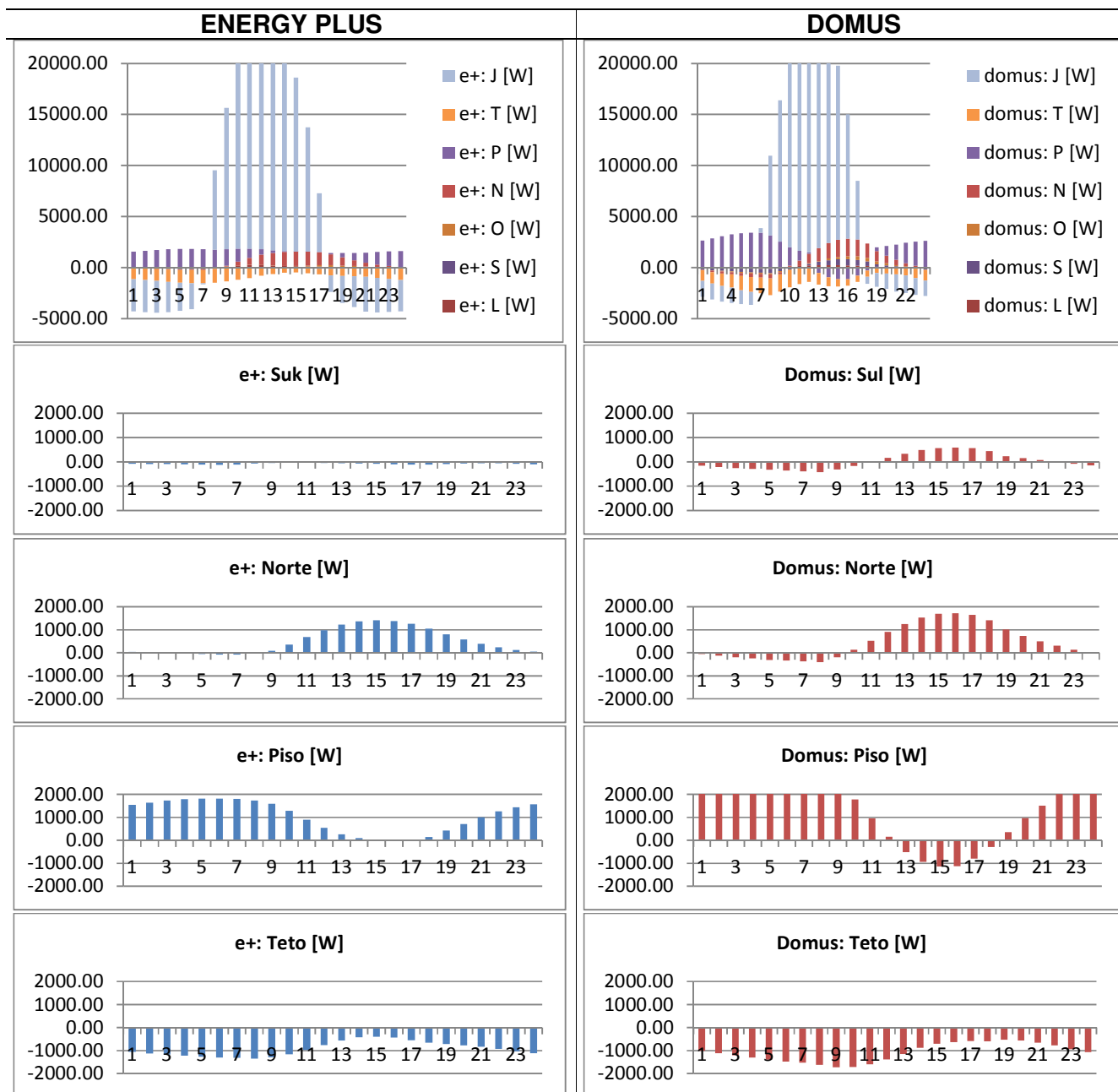
Figura 30: Ganho térmico do Domus e do Energy Plus no dia estável de verão (19/12) no protótipo de multizonas com janelas nas superfícies sul, norte, piso e teto no quinto andar
