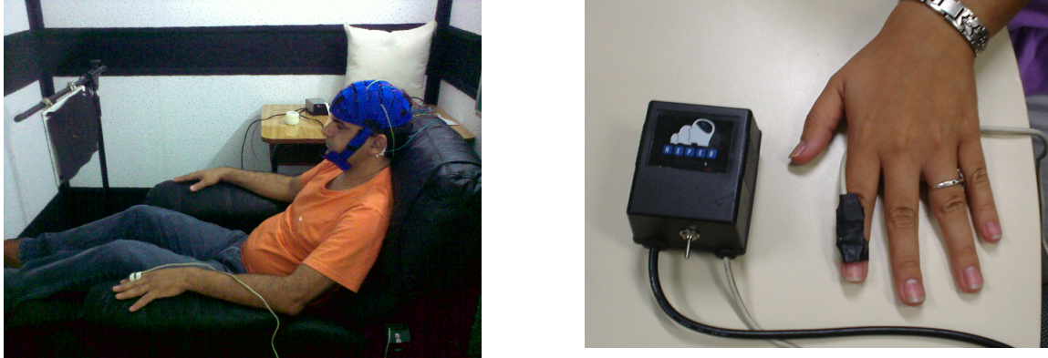
Figure 4.1 - Procedimento para a coleta do EEG. À esquerda o posicionamento do voluntário, bem como o painel com os LED's (à esquerda da mesma figura) utilizados para sincronizar os eventos. À direita o acelerômetro utilizado para detectar o movimento do dedo indicador da mão esquerda.
