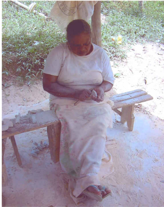
Figura 32 - Escultura manual em pedra-sabão: obtenção de formas iniciais com uso de canivete.
