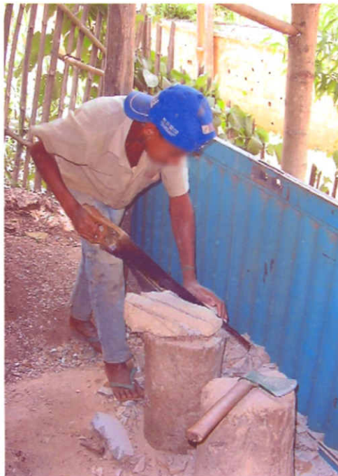
Figura 17 - Adolescente prepara bloco de pedra-sabão para ser trabalhado em torno elétrico.
