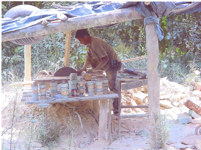
Figura 22 - Artesão cortando pedra-sabão na serra elétrica.
