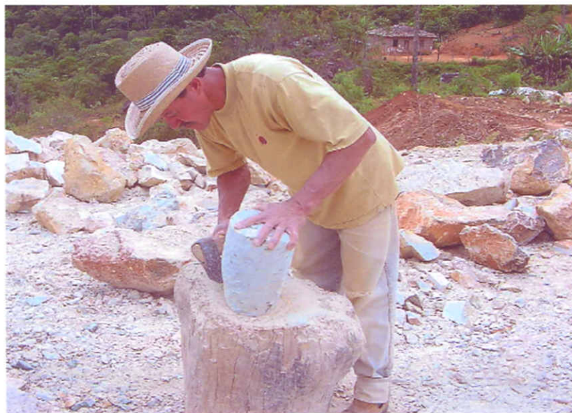
Figura 27 - Artesão "lavrando" bloco de pedra-sabão para processamento em torno elétrico.
