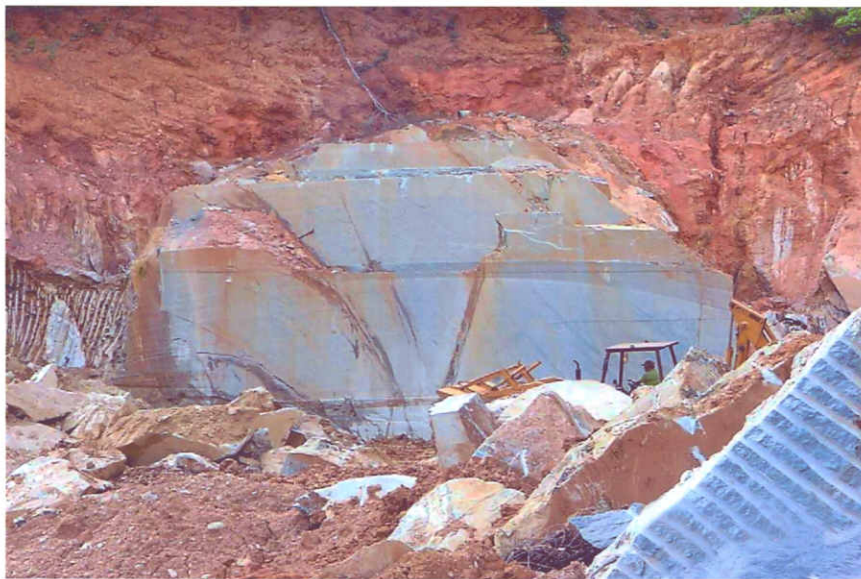
Figura 9 - Extração de blocos de pedra-sabão em mina próxima a Mata dos Palmitos, com utilização de teares com cabos de aço.
