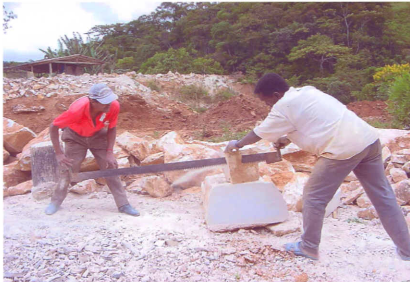
Figura 26 - Artesãos serrando bloco de pedra-sabão para processamento em torno elétrico.
