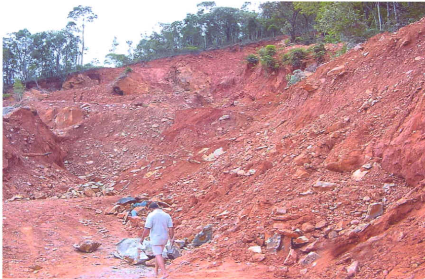
Figura 8 - Extração seletiva de blocos de pedra-sabão em mina próxima a Mata dos Palmitos.
