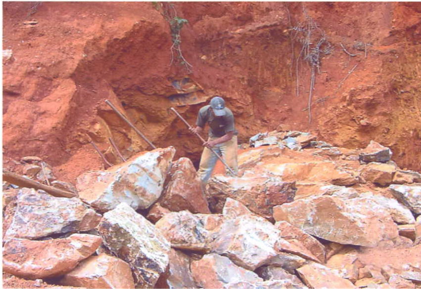
Figura 16 - Trabalhador quebrando blocos de pedra-sabão em mina próxima a Mata dos Palmitos.
