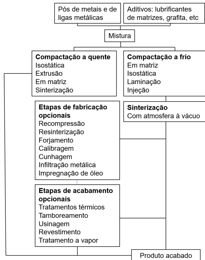
Figura 3: Esquema das etapas na Metalurgia do Pó. Fonte: Chiaverini, 1992 (adaptado).
