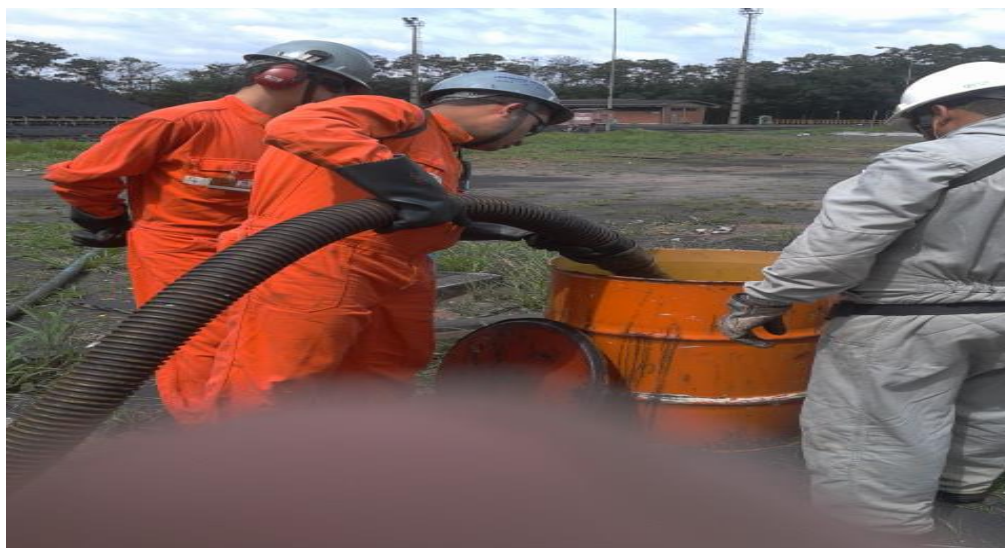
FIGURA 7 - O ajudante segurando o mangote durante uma sucção Fonte: Dados de pesquisa.
