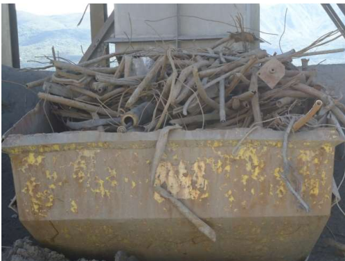
Figura 17 - Caçamba cheia de material não britável. metálico.
