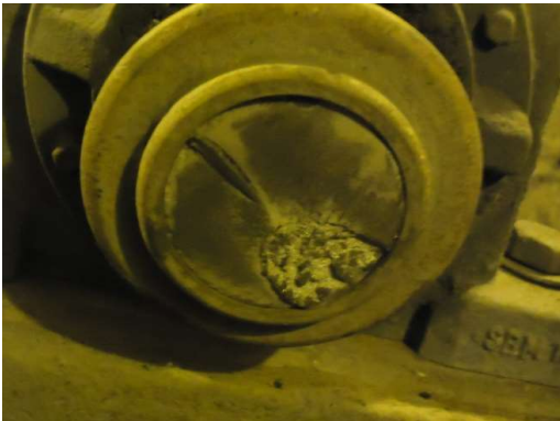
Figura 23 - Fratura do eixo preso ao mancal
