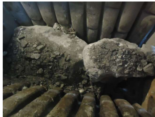
Figura 12 - Entupimento por matacões.
