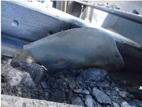
Figura 15 - Rasgo de correia po material metálico.
