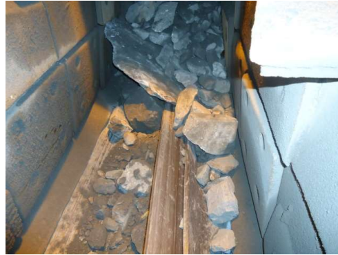
Figura 16 - Rasgo de correia por lamela do minério.
