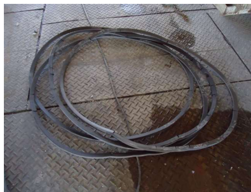
Figura 28 - Correias danificadas de acionamento do britador.
