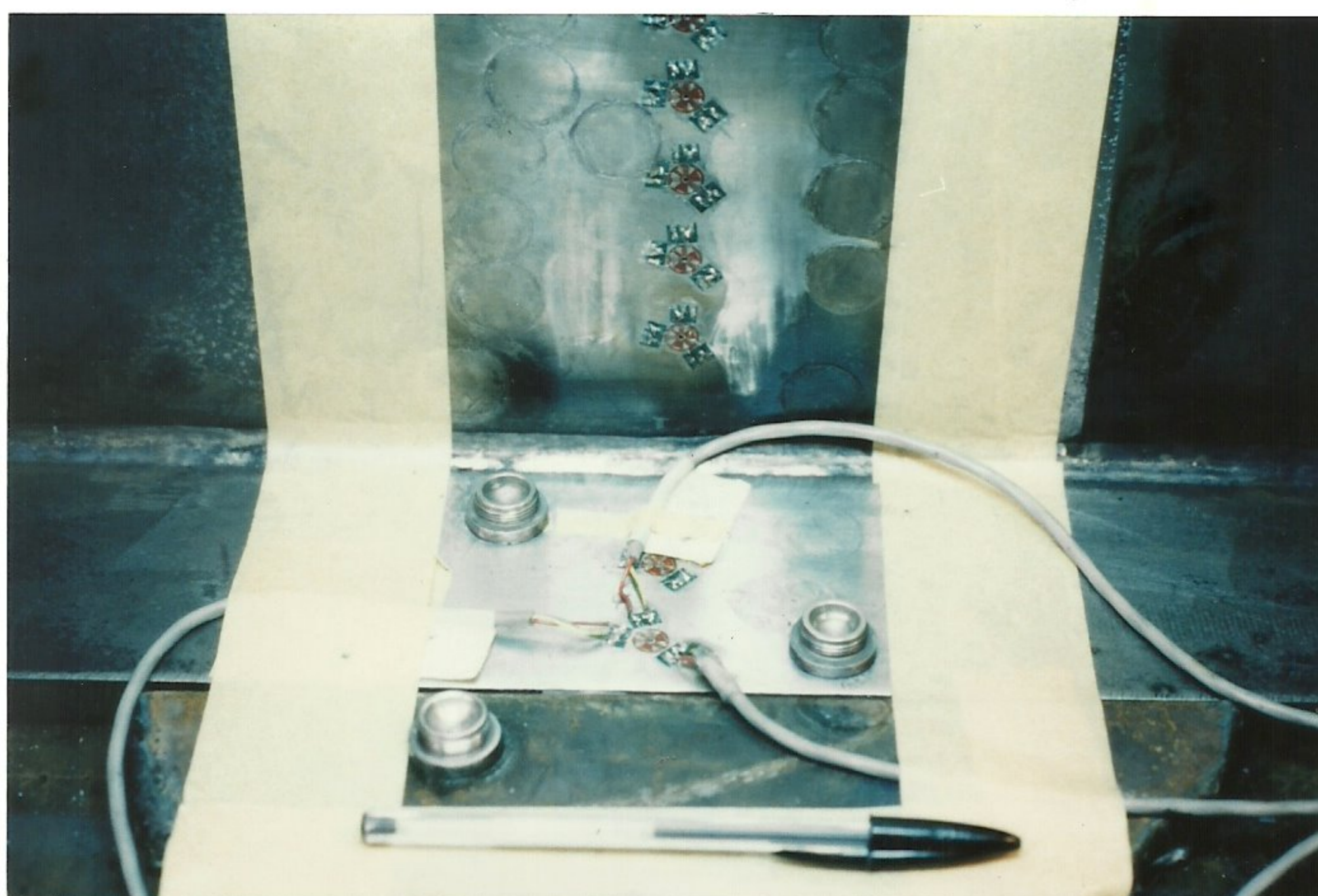
Figura 4.8 - Ligação dos cabos à roseta de deformação
