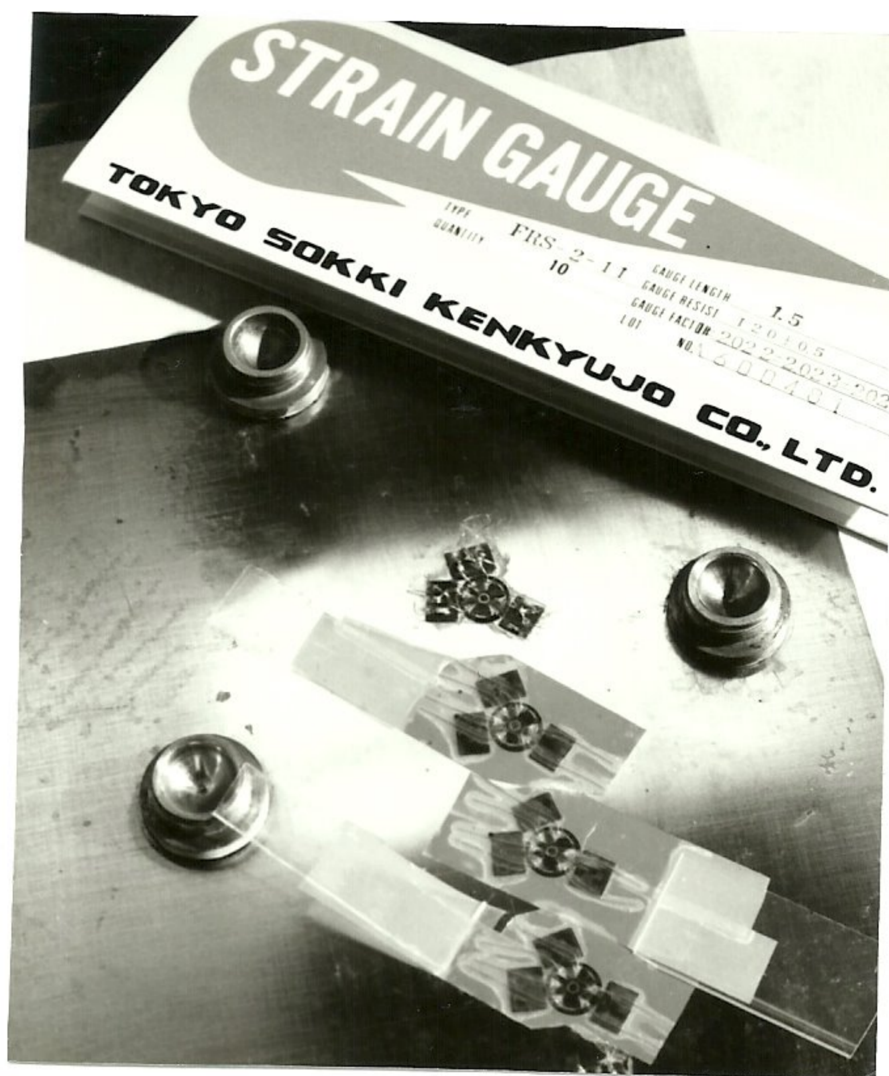
Figura 4.4 - Roseta de deformação e terminais de conexão
