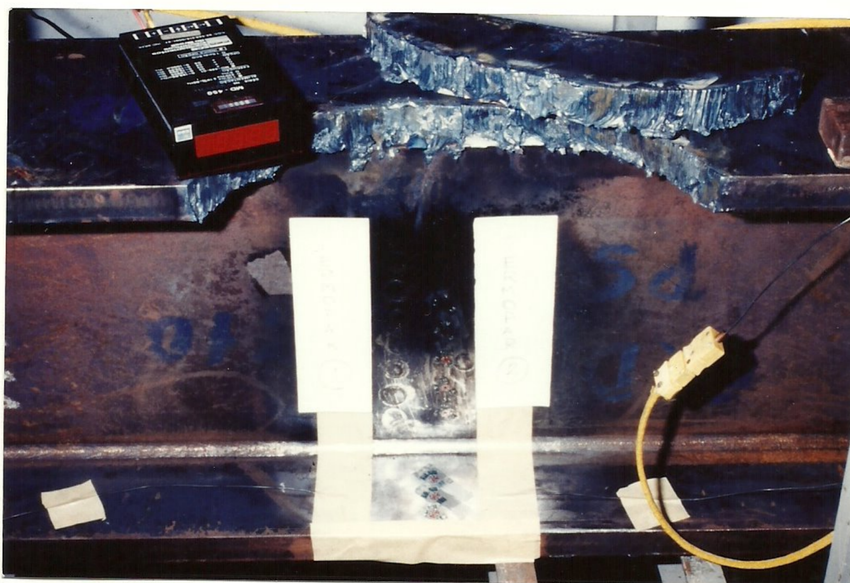
Figura 01 - Corte em perfil instrumentado para avaliação de variação de temperatura e de deformação
