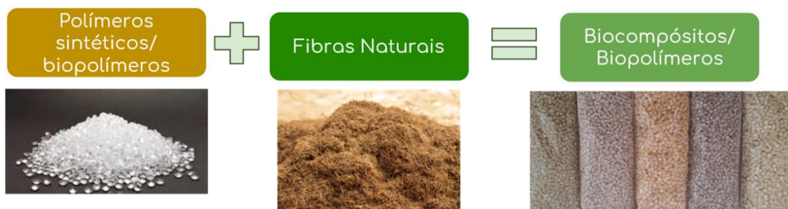
Figura 38: Esquema necessário para a confecção de biocompósitos.
