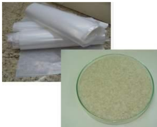
Figura 39: Plástico descartado sendo utilizado para a fabricação de biocompósito.
