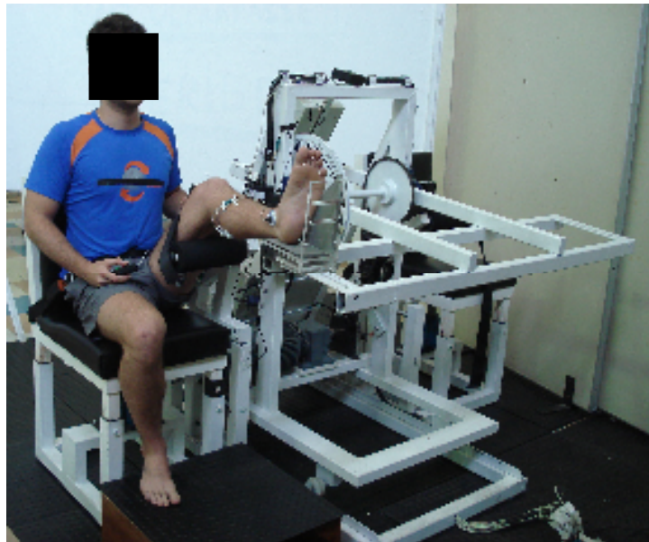
FIGURA 5 - Mensuração da ADM_{MÁX} , PSDA_{ADM} e torque máximo. Fonte: Arquivo de fotos do BIOLAB.
