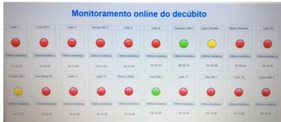
Figura 9 - Fotografia do Painel de leitura do programa MatLab: Alertas de mudança de decúbito conforme as cores verde, amarelo e vermelho
