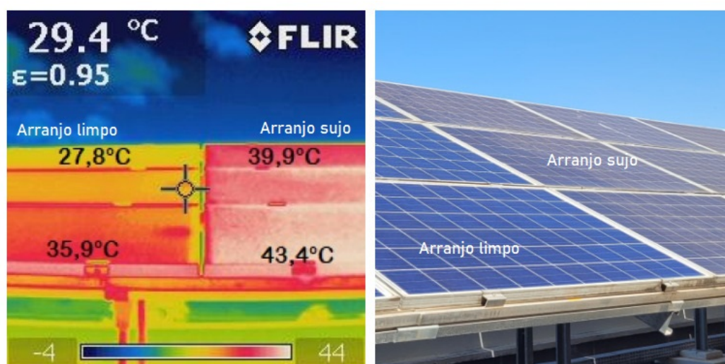
Figura 29 – Comparativo entre Sistema Limpo e Sujo.
