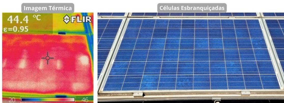
Figura 30 – Comparativo Térmico x Real de Células Esbranquiçadas.
