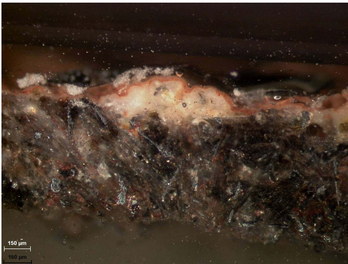
Figura 152 – Corte estratigráfico da amostra SMS-1, evidenciando a espessura do filme de pigmento vermelho. Sitio Manantial Solis, Parque Nacional Perito Moreno, Argentina.
