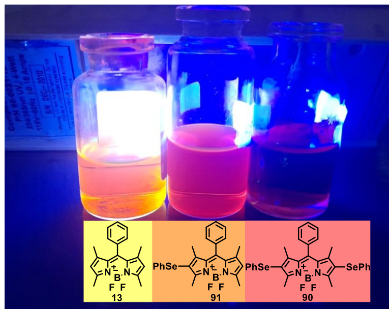
Figura 20. BODIPY sem substituinte ( 13 ), com uma fluorescência na região do amarelo, monosubstituído ( 91 ), com uma fluorescência na região do laranja, e dissustituído ( 90 ), com uma fluorescência na região do vermelho, iluminados pela lâmpada de UV-254 nm e a diferente cor de emissão.
