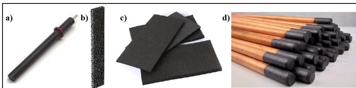
Figura 5. Diferentes tipos de eletrodos de carbono, em a) o de carbono vítreo, 55 b) o RVC 56 , c) o feltro de carbono 57 e d) eletrodo de grafite. 58
