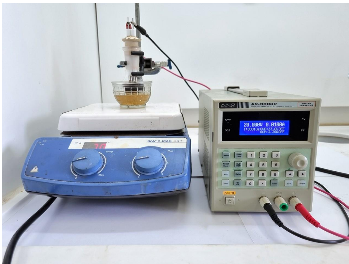
Figura 12. Montagem do sistema de eletrossíntese de célula não dividida utilizado, sendo composto por um galvanostato, uma chapa de aquecimento e pares de eletrodos.
