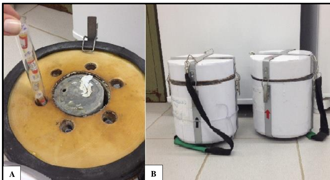
Figura 3. Container utilizado para o resfriamento lento, pré-congelamento do PRP. A) Visão interior do container, com amostras prontas para refrigeração. B) Visão exterior do container utilizado no presente experimento
