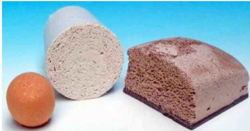
Figura 3.9- Amostras de geopolímero expandido de isolamento térmico (Na,K)-Poli (sialate-siloxo) para produção de painéis.
