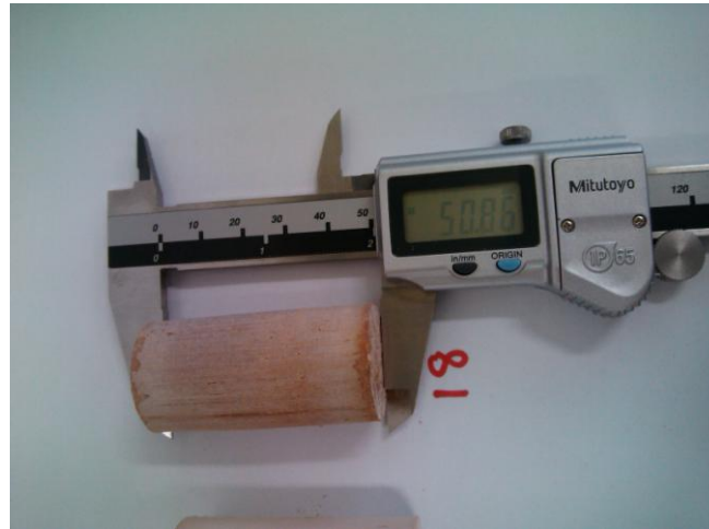
Figura 4.6- Aferição de medidas após a cura em diferentes temperaturas e idades.
