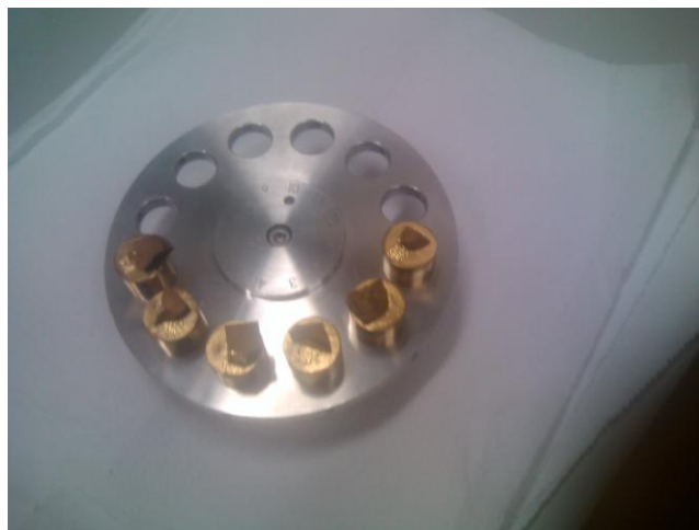
Figura 4.7- Amostras revestidas com ouro para ensaio de fotomicrografias no microscópio eletrônico de varredura (MEV).
