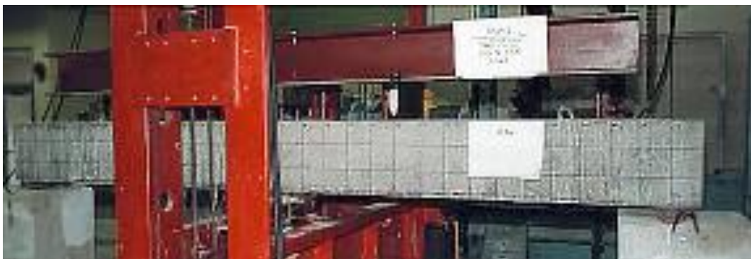
Figura 3.12- Viga de concreto geopolimérico com camadas de composto de carbono aplicados na sua superfície inferior
