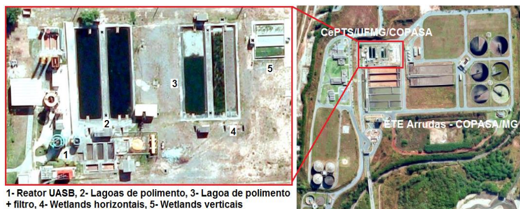
Figura 6.1: Unidades experimentais de tratamento do CePTS/UFGM/COPASA localizadas nas dependências da ETE-Arrudas/COPASA.
