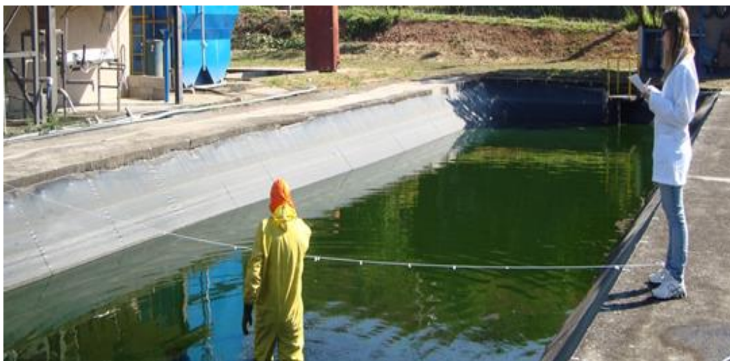
Figura 6.10: Batimetria das lagoas de polimento realizada a pé com demarcação por piqueteamento.
