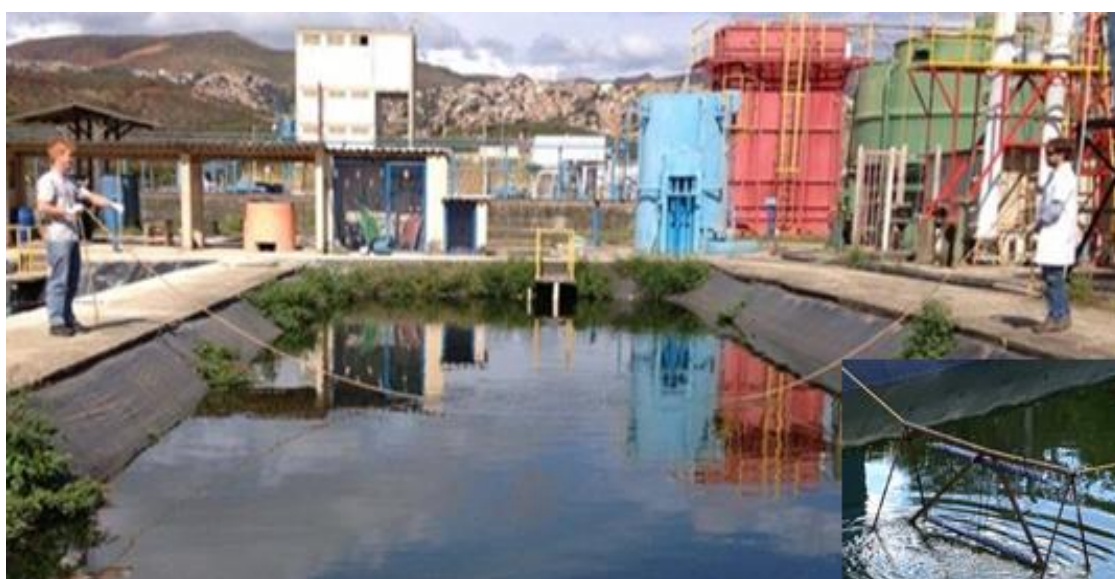
Figura 6.14: Amostragem de OD, T, POR e pH com as sondas multiparamétricas YSI 600 XLM no meio da primeira lagoa polimento.
