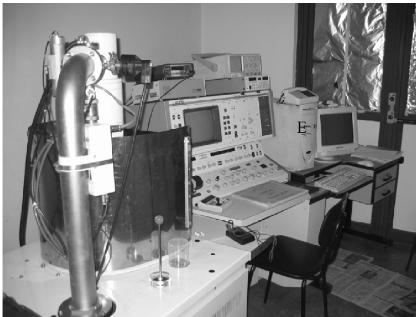
Fig 3.11 – Fotografia de todo o sistema de controle do microscópio, que inclui, um painel e um computador.
